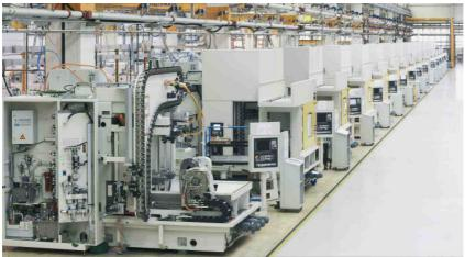
Das erste System mit SPECHT 450 DUO Maschinen für eine Zylinderkopfbearbeitung in hohen Stückzahlen produziert bereits beim Kunden.
