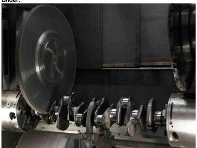
Kombination Hartfein-Fräsen und Hartfein-Finishen in einer Aufspannung. Downloadlink:
